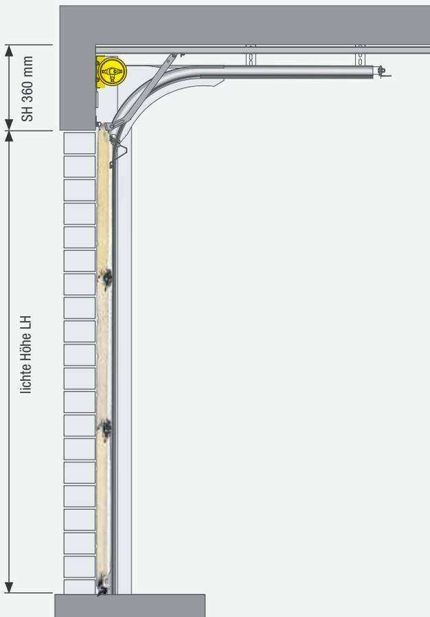
**Beschlag 6. FH - Automatik** Sturzhöhe 360 mm (Sturzhöhe 420 mm mit Verstärkung)
